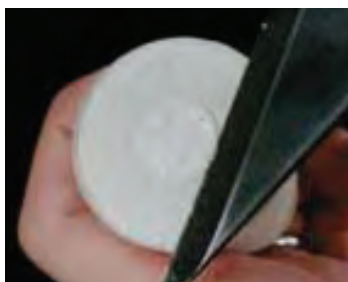
Снимите верхушку формовочной массы, образованную выравнивающей крышкой
