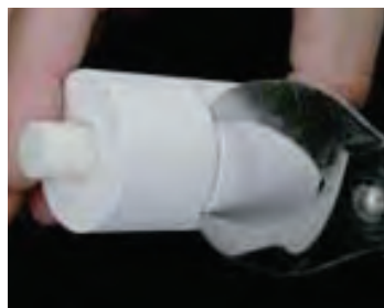
Окончательное удаление паковочной массы с помощью кусачек для гипса
