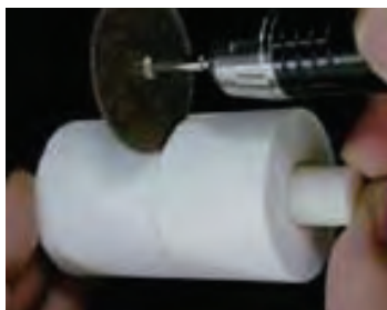
Разрезание с помощью сепарационного диска
