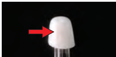
Образование трещины в процессе шлифования
