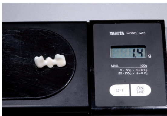
Взвесьте каркас из ZirCAD и запишите значения.
