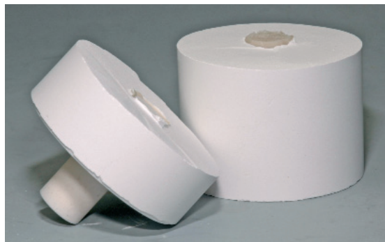
Надрежьте опоку с помощью сепарационного диска и разломите ее по сделанному надрезу.
