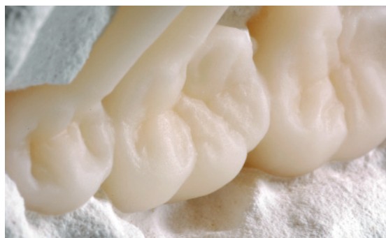
Черновая распаковка осуществляется стеклянной полировочной дробью под давлением 4 атм (60 psi). Окончательная распаковка проводится под давлением 2 атм. (30 psi).
