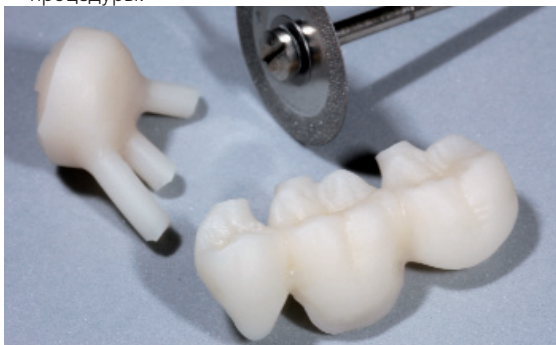
Отрежьте литники с помощью мелкозернистого алмазного диска.
