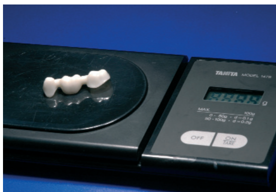
Взвешивание каркаса из ZirCAD и запись значения
