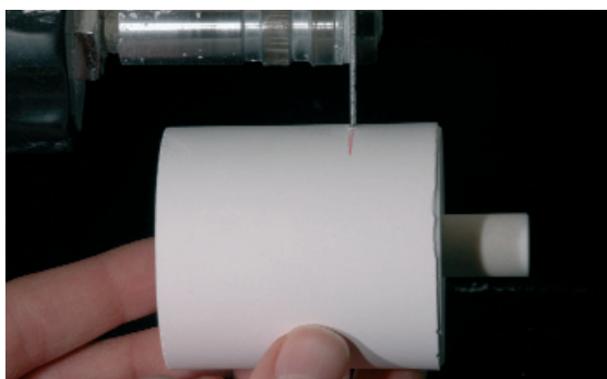
Надрежьте опоку с помощью сепарационного диска и разломите ее по сделанному надрезу.
