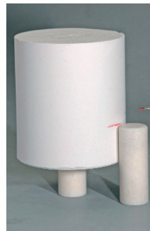
Отметьте длину алюмооксидного плунжера на охлажденной опоке.
