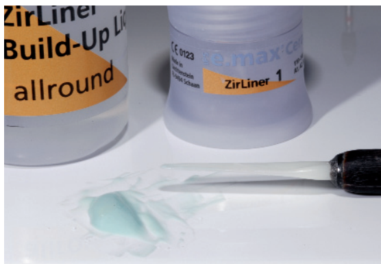
Смешайте ZirLiner желаемого цвета с соответствующей жидкостью до кремообразной консистенции и полностью покройте каркас.
