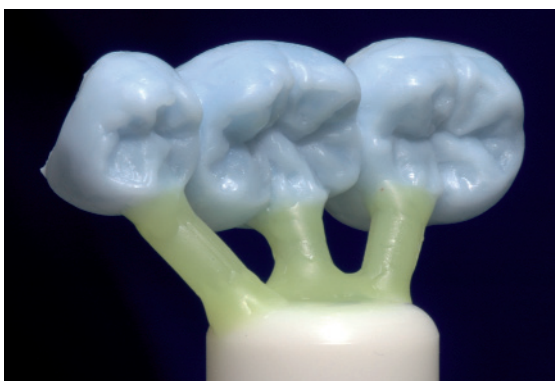
Устанавливайте литники на цоколь муфельной системы IPS e.max всегда в направлении потока керамики и к самой массивной части реставрации.
