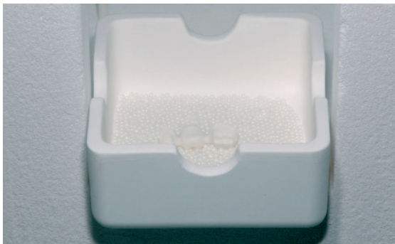
По завершении спекания дайте лотку остыть до комнатной температуры и выньте его из печи Sintramat
