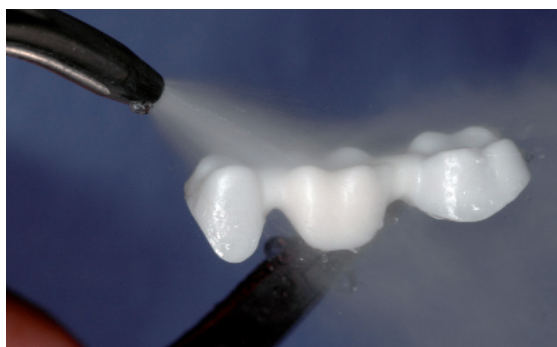
Очистите каркас паром перед облицовкой.
