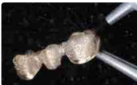
Каркас подвергнуть тщательной пескоструйной обработке оксидом алюминия Al_2O_3 (80–100 мкм) и при давлении 2–3 бара, обстучать инструментом.
