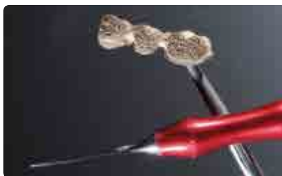
Каркас подвергнуть тщательной пескоструйной обработке оксидом алюминия Al_2O_3 (80–100 мкм) и при давлении 2–3 бара, обстучать инструментом.
